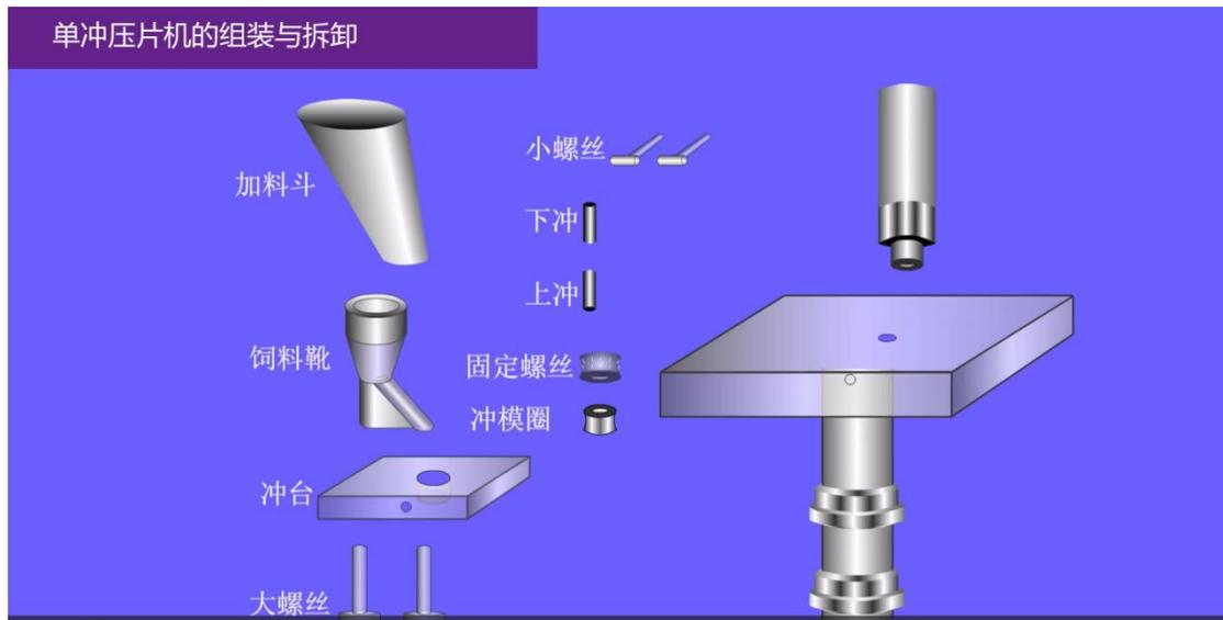
图 22. 单冲压片机的组装与拆卸
